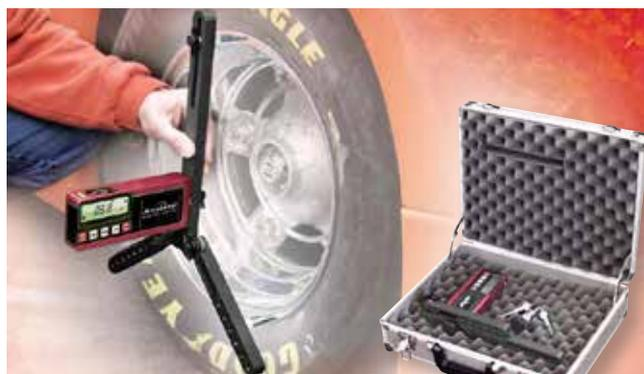
Misuratore digitale per la calibrazione delle ruote.
