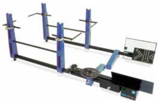
Trak-Rite PPL40+ è l'evoluzione dell'originale PPL40, l'indicatore di allineamento ruote standard del settore per quasi 30 anni. Le differenze principali sono le colate più ergonomiche, una migliore unità laser e il montaggio del braccio oscillante. La leggenda del PPL40 continua per durata, precisione e praticità. Ideale per ruote e pneumatici workshop, gruppi di binari Autosport e carrozzerie di riparazione.
