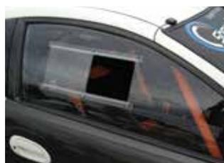
Presca d'aria termoformata chiara, attribuisce al nostro kit Base un elevato volume di aria aspirata in macchina. 3 millimetri di spessore in plastica chiara, termoformato e forato, si adatta al kit Base Small.
