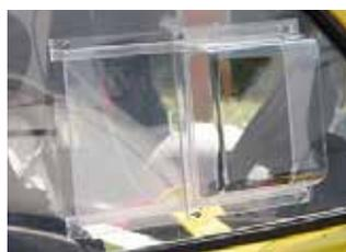
Presca d'aria termoformata chiara, attribuisce al nostro kit Base un elevato volume di aria aspirata in macchina. 3 millimetri di spessore in plastica chiara, termoformato e forato, si adatta al kit Base Large.
