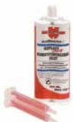
Resina epossidica pura senza stirene potente, per carichi sismici. Applicazione facile e veloce. Tempo di lavorazione 4 minuti a 23°C. Tempo indurimento 60 minuti a 23°C. Ancorante chimico per barre filettate, ferri e ancoraggi nel legno.
